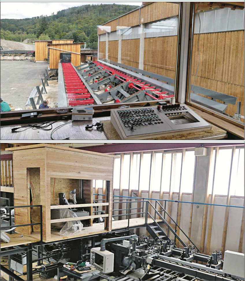
Bei der Anlagengestaltung ging es auch um größtmögliche Übersicht für die Anlagengführer zur Qualitätsbeurteilung sowohl des Rund-, als auch des Schnittholzes: Im Bild oben der Blick vom Leitstand für den Rundholz-Bearbeitungsstrang, im Hintergrund die Einhausung der 3-D-Vollkonturmessung, rechts die Sägehalle. Im Bild unten der Leitstand an der „BNK“-Nachschnittseinheit – zusätzlich zum üblichen Kontroll-Panel an der Anlage – ermöglicht von oben eine bessere Sicht auf die Ware als von der üblichen Position des Bedieners aus.
