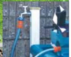
Wasserzufuhr von einem Hauswasseranschluss
