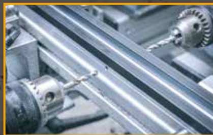
Bohrungen für die Seildurchführungen
